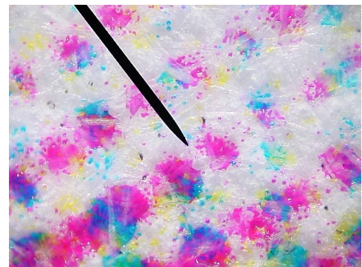
Színes lézernyomtatott kép mikroszkópos felvétele
